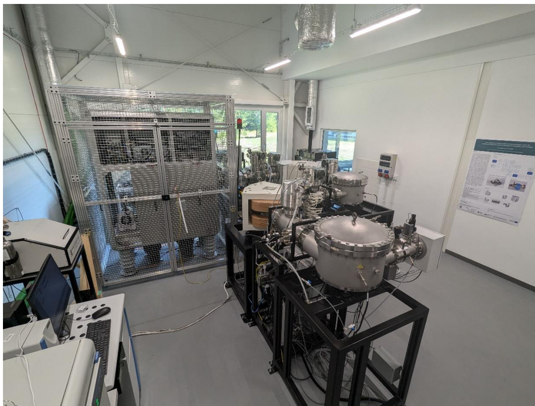
Ryc. 2. Spektrometr mas jonów dodatnich (PIMS - Positive Ion Mass Spectrometer) w Laboratorium Radioizotopowych Analiz Środowiskowych AGH. Fot. J. Pawlyta
